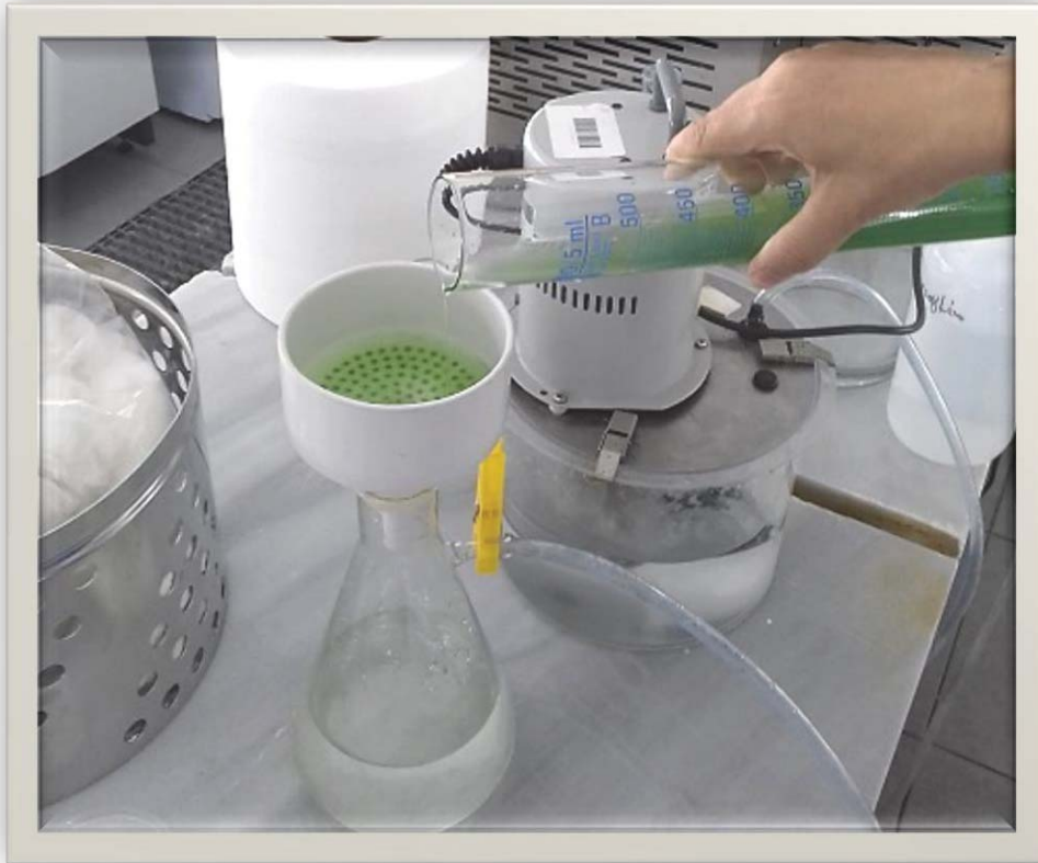
Σχήμα 8. Αντλία κενού και φίλτρο προκειμένου να συλλεχθεί η υγρή μάζα των νηματοειδών κυανοβακτηριακών μικροφυκών.
