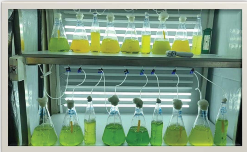
Σχήμα 63. Τα δοχεία καλλιέργειας του Asteromonas gracilis την 20 η ημέρα με το χρώμα τους να ποικίλλει ανάλογα με τη συνθήκη από κιτρινωπό στον έντονο φωτισμό (υπερώριμη καλλιέργεια, επάνω ράφι) έως ανοικτό πράσινο στον ασθενή φωτισμό (ωριμάζουσα καλλιέργεια, κάτω ράφι).
