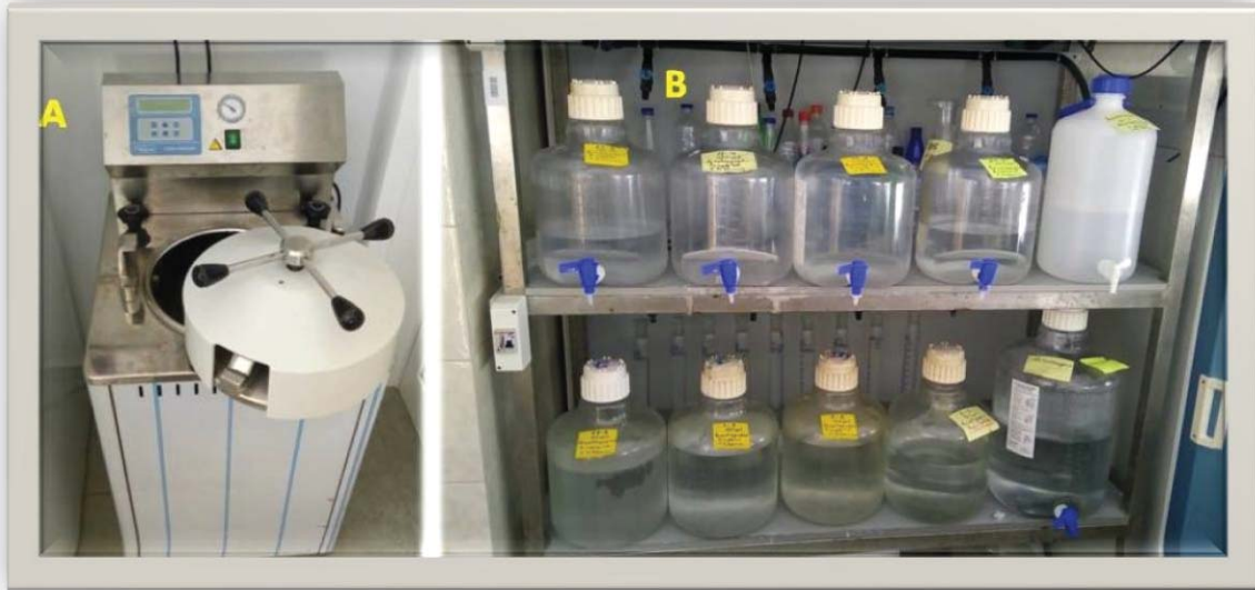
Σχήμα 14. Η συσκευή του αυτόκαυστου (A) και (B) τα 12 L χωρητικότητας δοχεία Nalgene με το αποστειρωμένο και λιπασμένο αλμυρό νερό διαφόρων αλατοτήτων.
