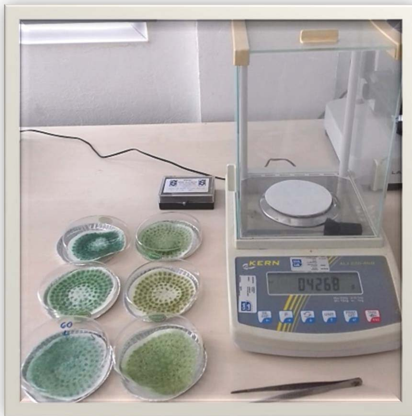
Σχήμα 10. Ηλεκτρονικός ζυγός ακριβείας 0,0001 g που χρησιμοποιήθηκε για τη ζύγιση των ηθμών.
