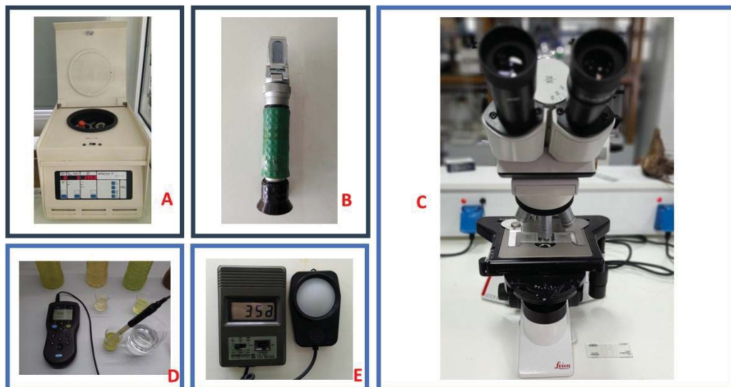
Σχήμα 15. Χρησιμοποιηθέντα όργανα. A: Φυγόκεντρος, B: Διαθλασίμετρο-αλατόμετρο, C: Μικροσκόπιο Leica, D: ηλεκτρονικό πεχάμετρο, E: Λουξόμετρο.
