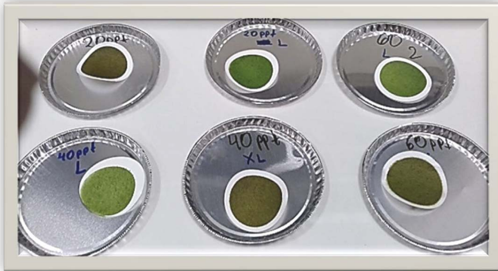
Σχήμα 11. Αποξηραμένα φίλτρα GF/C πόρων 0,45 μm, με την ξηρή μάζα μικροφυκών έτοιμα για ζύγιση.
