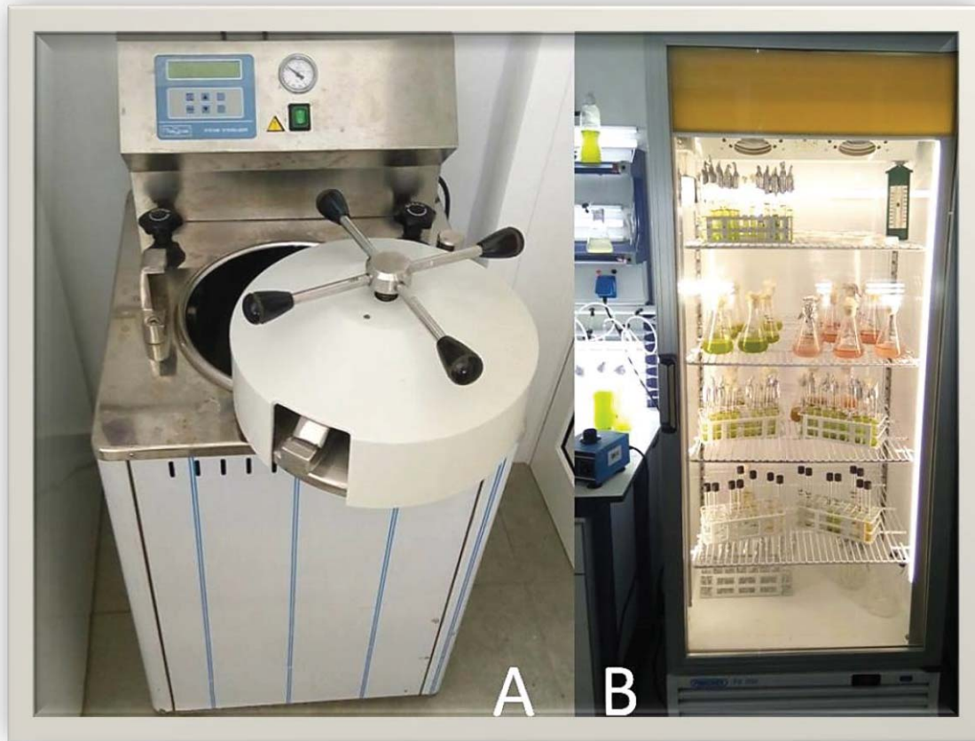
Σχήμα 2. Κλίβανος αποστείρωσης (A) υψηλής πίεσης (αυτόκαυστο) που χρησιμοποιήθηκε για την αποστείρωση του νερού των καλλιεργειών και των θρεπτικών διαλυμάτων. Θερμοθάλαμος (B) με τις καθαρές αποθεματικές καλλιέργειες των ειδών φυτοπλαγκτού.
