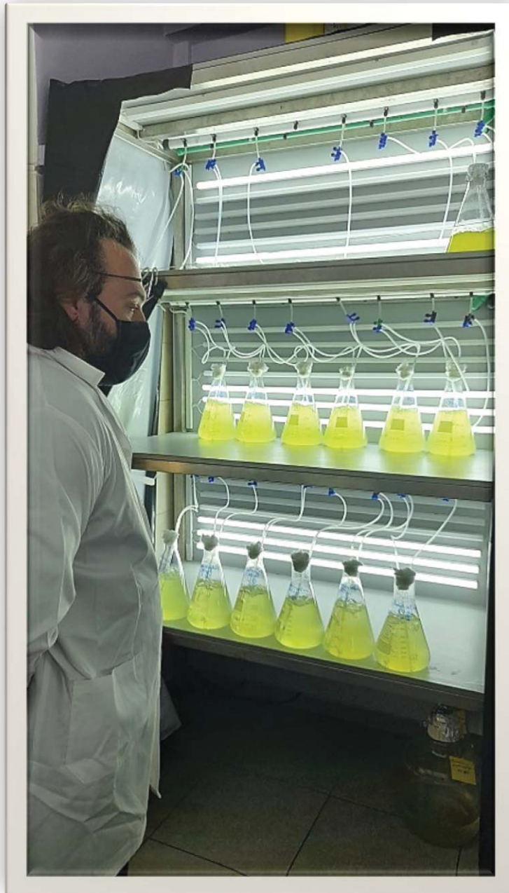
Σχήμα 3. Το σύστημα των ραφιών για τα δοχεία με τις καλλιέργειες μικροφυκών και με συστοιχίες των λαμπτήρων LED και τις παροχές αέρα.
