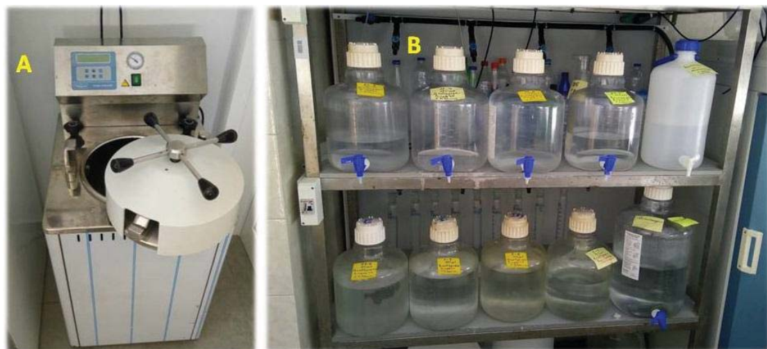
Σχήμα 2. Η συσκευή του αυτόκαυστου (A) και τα 12 L χωρητικότητας δοχεία Nalgene με το αποστειρωμένο και λιπασμένο αλμυρό νερό διαφόρων αλατοτήτων.
