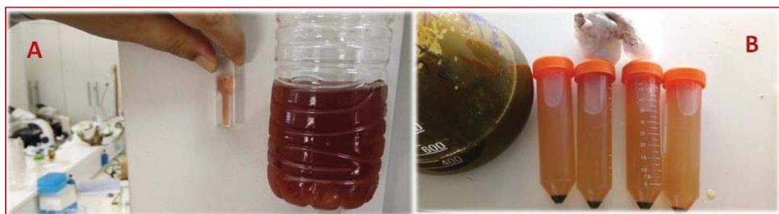
Σχήμα 38. Στο A υπερκείμενο κόκκινο νερό από φυγοκεντρημένη ποσότητα με την κυβέτα δίπλα που θα φωτομετρηθεί. Στο B οι σωλήνες με το φυγοκεντρημένο δείγμα όπου το υπερκείμενο είναι κοκκινωπό και το ίζημα που περιέχει τα κύτταρα είναι πρασινωπό.
